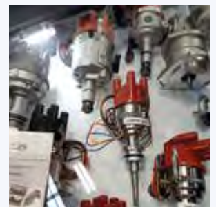
Nederlandske 123 lagar heil-elektronisk tenning til mange europeiske bilar som erstattar heile fordelaren. Prisar frå 300 Euro.
